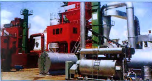
Trạm trộn bê tông nhựa nóng 80-104 tấn/giờ
